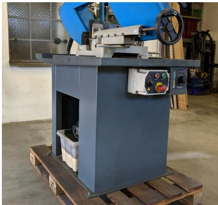
Obr. 5) Stávající stojan a řešení ovládacího panelu
