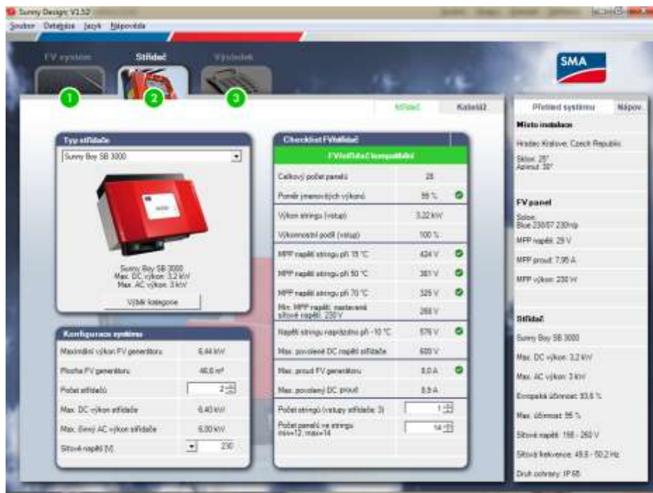
Obr. 7 – 4 Dimenzování FV střídače [23]
