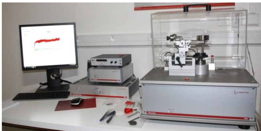
Obr. 29 – Tribometr pro suché i kapalně prostředí
