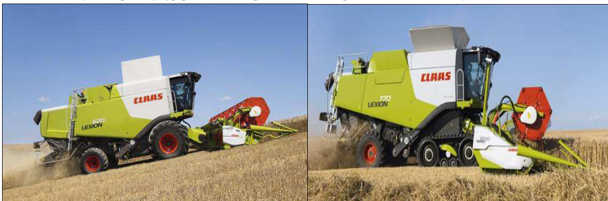
Obr. 26 Kolový nebo pásový typ podvozku na přední hnané nápravě sklízecí mlátičky
