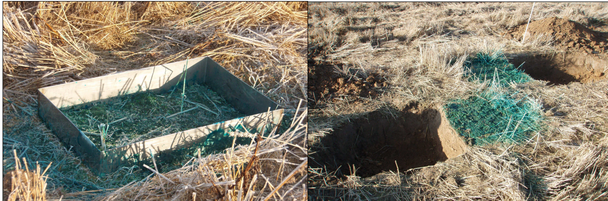
Obr. 36 Vsáknutý 0,3 % roztok modrého barviva s vodou v měřicím bodu a vykopané jámy
