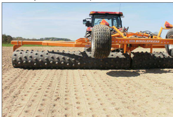
Obr. 11 Příklad válce Aqueel 2 od výrobce SIMBA Great Plains, který zanechává na povrchu profil s důlky miskovitěho tvaru a minimalizuje tím účinky vodní eroze a zajišťuje lepší vsakování vody
