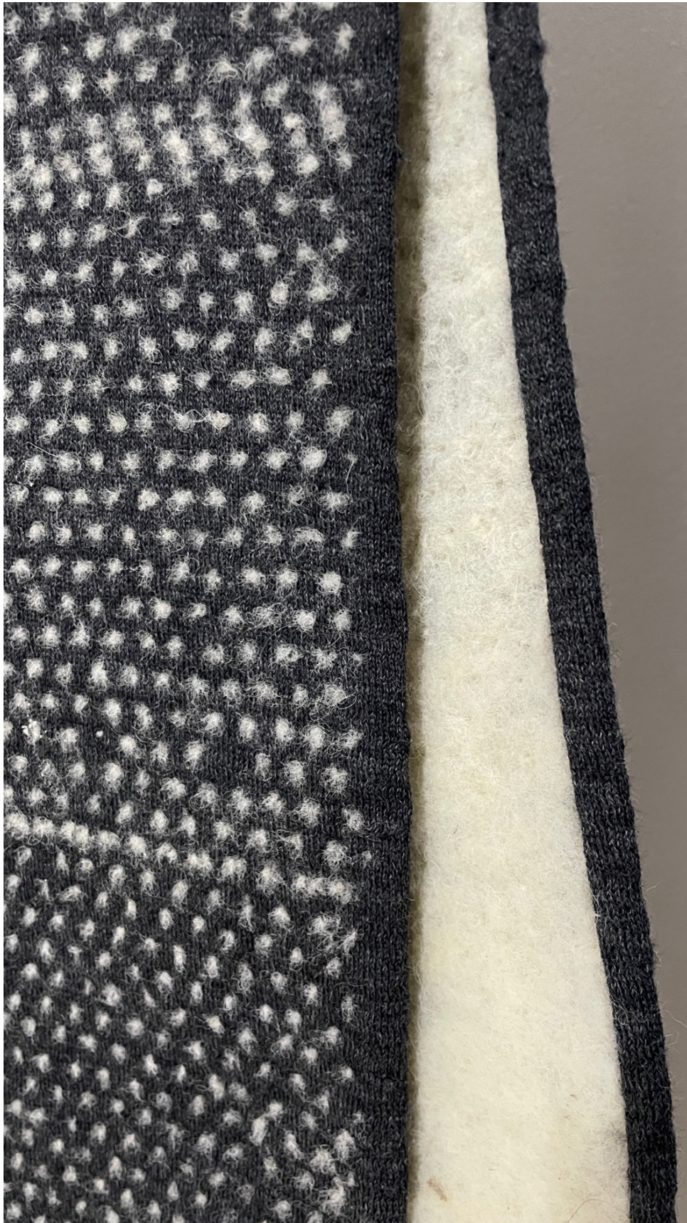
Obr. 55: Autorská textilie, propojení netkané textilie a jednocícní pleteniny pomocí vpichování [21]
