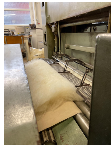
Obr. 47: Vrstva vlny těsně před vstupem do vpichovacího ústrojí [21]
