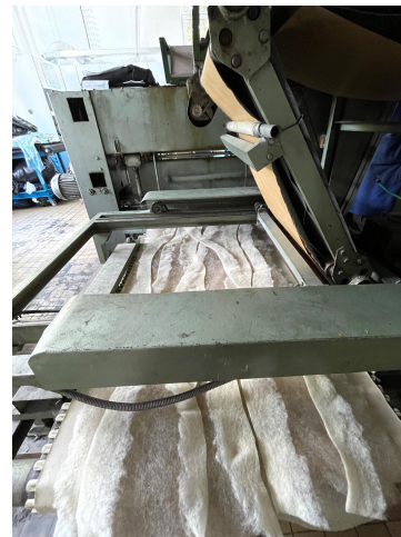
Obr. 50: Pohled zezadu vpichovacího ústrojí, kam se materiál musel dopředu nachystat [21]
