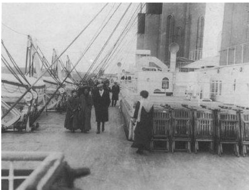
Obr. 20 Paluba Titaniku – na levé straně jsou vidět záchranné čluny, lidé se procházejí místy, které bylo navrženo pro další záchranné čluny. [2]
