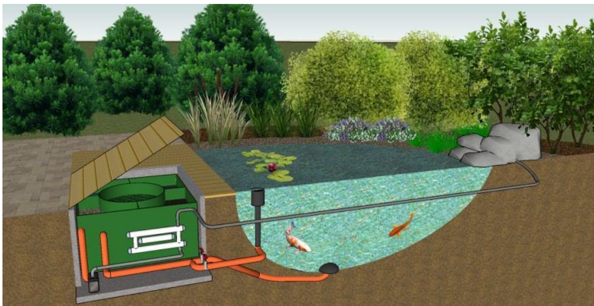
Obrázek 27: Ukázka propojení skimmeru s ostatní technikou (gravitační zapojení) [48]
