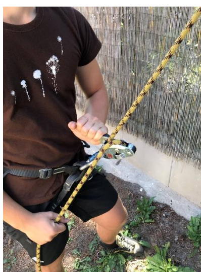
Obrázek č. 44: Spouštění s Gri-Gri (zdroj: vlastní)
