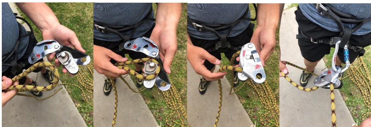
Obrázek č. 42: Navlékání lana do Gri-Gri (zdroj: vlastní)
