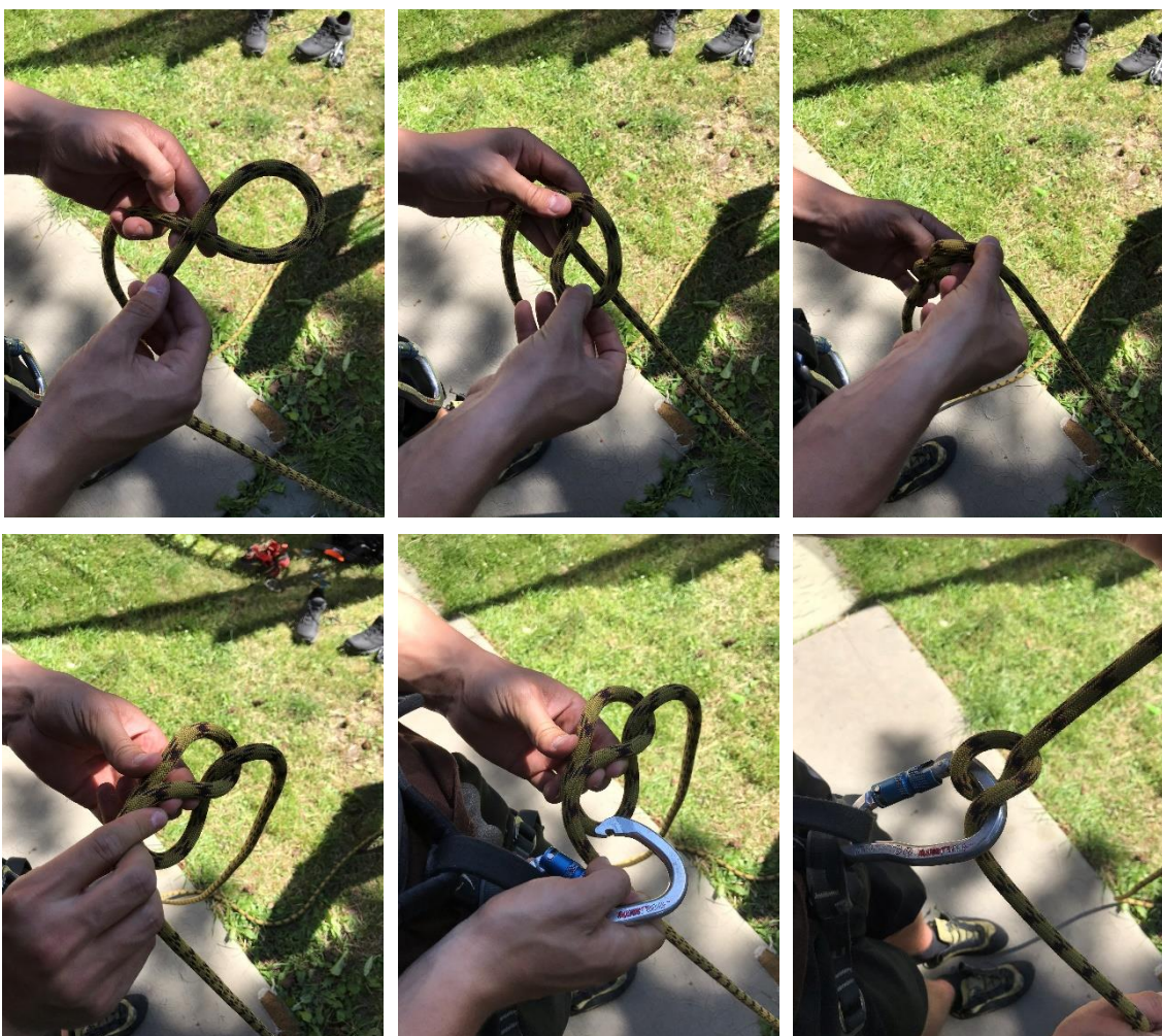
Obrázek č. 39: Vázání půllodního uzle (zdroj: vlastní)
