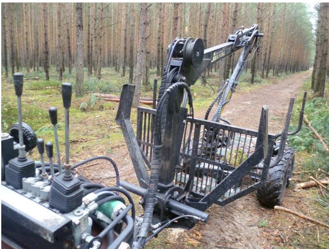
Příloha 14: Vyzvězací přívěs a ovládací prvky hydraulické ruky (vlastní fotografie)
