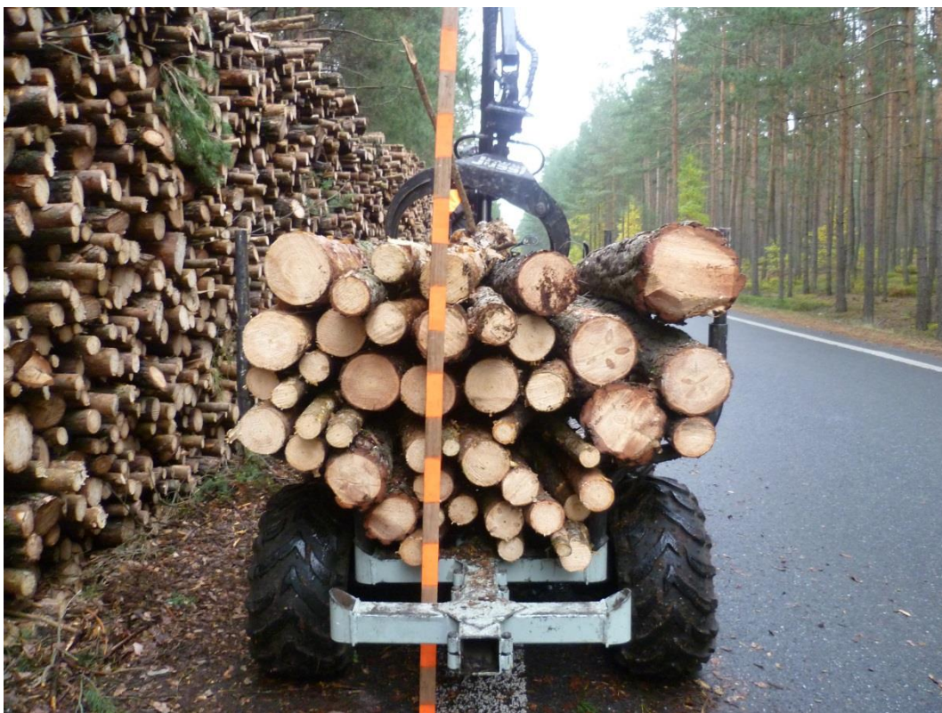
Příloha 12: Měření výšky nákladu (vlastní fotografie)
