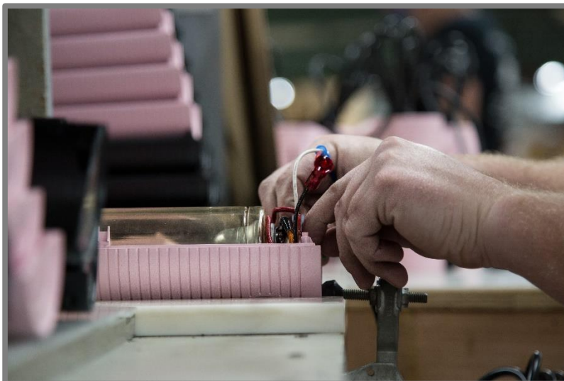
Obr. 2-7 Ruční montáž napařovače Esteam [8]
