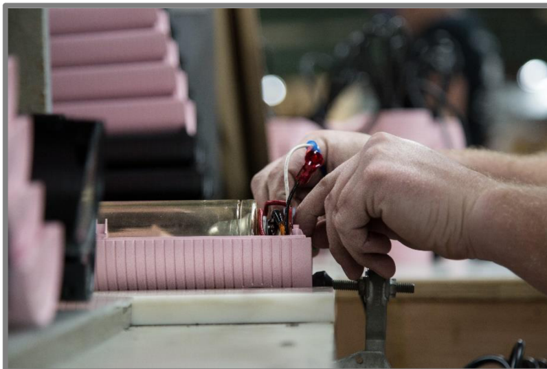
Obr. 2-7 Ruční montáž napařovače Esteam [8]
