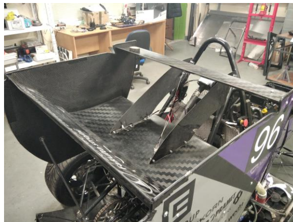
Obrázek 1.1: Stávající uchycení zadního přítláčného křídla (desky z kompozitu)
