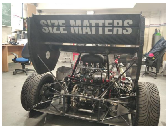
Obrázek 1.2: Stávající uchycení zadního přítláčného křídla (ocelové tyče)
