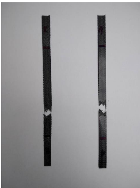
Obrázek 7.7: Tvar lomu zkušebních vzorků
