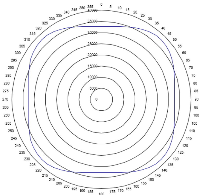
Obrázek 7.11: Modul pružnosti v tahu v závislosti na úhlu natočení vrstvy kompozitu
