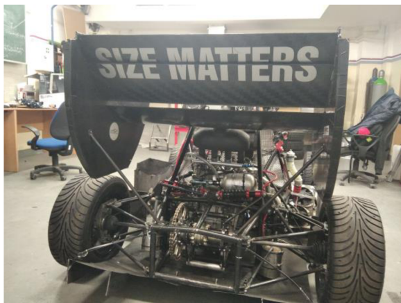
Obrázek 1.2: Stávající uchycení zadního přitlačného křídla (ocelové tyče)
