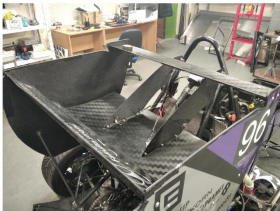
Obrázek 1.1: Stávající uchycení zadního přitlačného křídla (desky z kompozitu)
