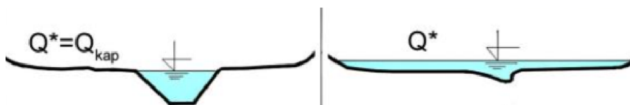
Obr. 8 - Schématické tlumení průběhu velkých vod [6]
