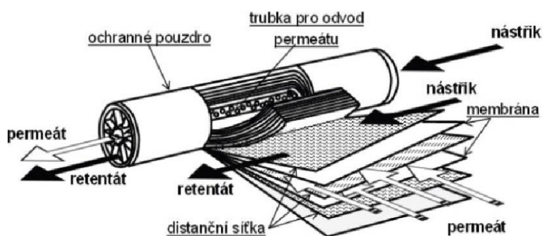
Obr. 17 Špirálovo vinutý modul[18]
