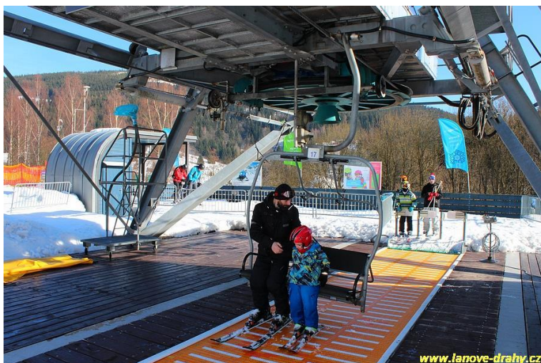
Obr. 72 Nástupiště lanovky „N“, pojízdný pás ( http://www.lanove-drahy.cz/fotogalerie/fotky/labska/labska49.jpg )
