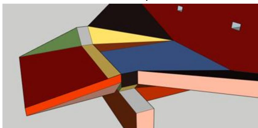
**Obr. 36 Detail na vývar přehrážky**
