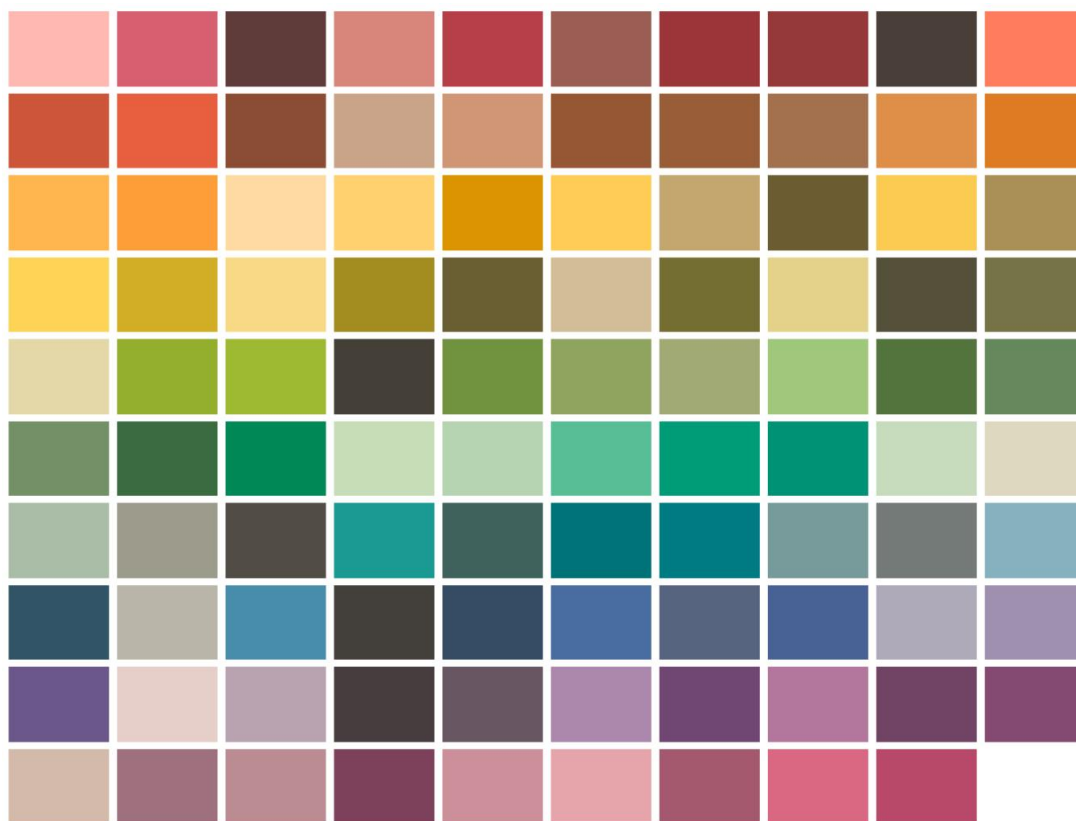
Obr. 5-4: Barevné vzorky, používané pro určení indexu podání barev dle TM-30-15 [58].
