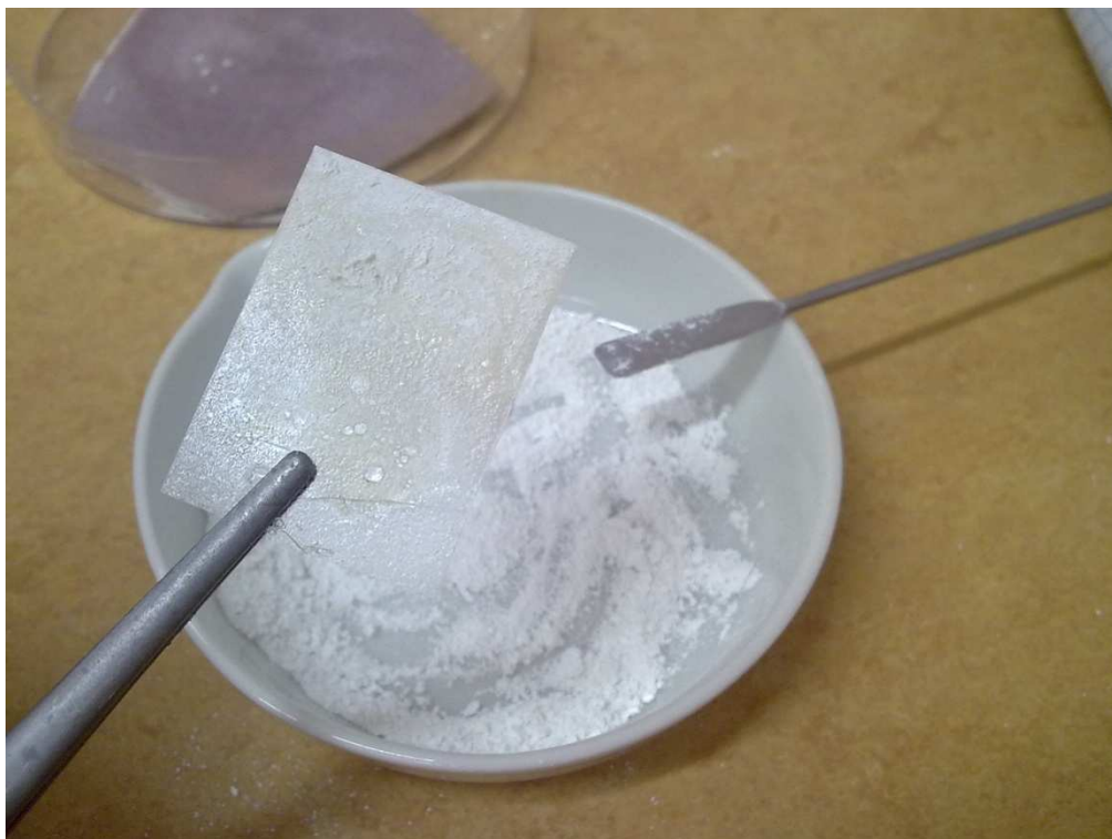
Příloha 2: Nanášení práškového materiálu na skleněnou destičku opatřenou lepidlem
