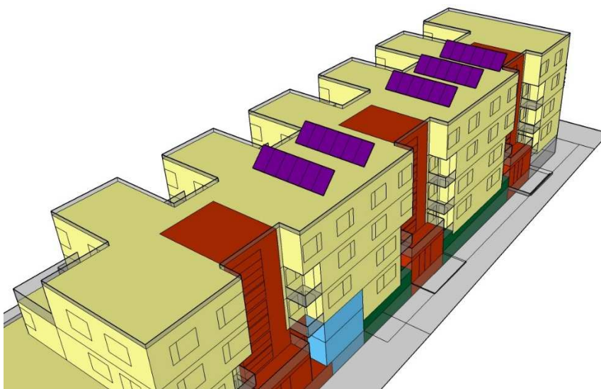
Obrázek 44: Schéma solárních kolektorů umístěných na střeše objektu
