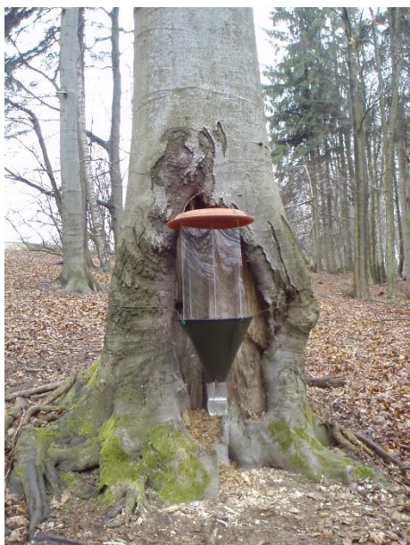
Obrázek č. 10 Pasivní nárazová kmenová past s označením 16D, místo nálezu Crepidophorus mutilatus , čelní pohled
