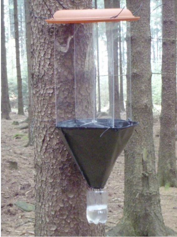
Obrázek č. 8 – Pasivní nárazová kmenová past umístěná na smrku ztepilém
