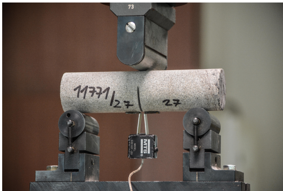
Obr. 5.1: Detail zkoušky pískovcového tělesa v lisu (Kubeš (2016))
