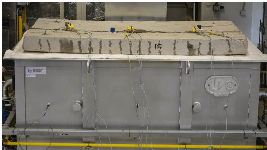
Obr. 5.4: Pec pro zkoušky požáru stavebních materiálů v centru AdMaS (Rozsypalová et al. (2017), Šimonová, H. et al. (2017b))
