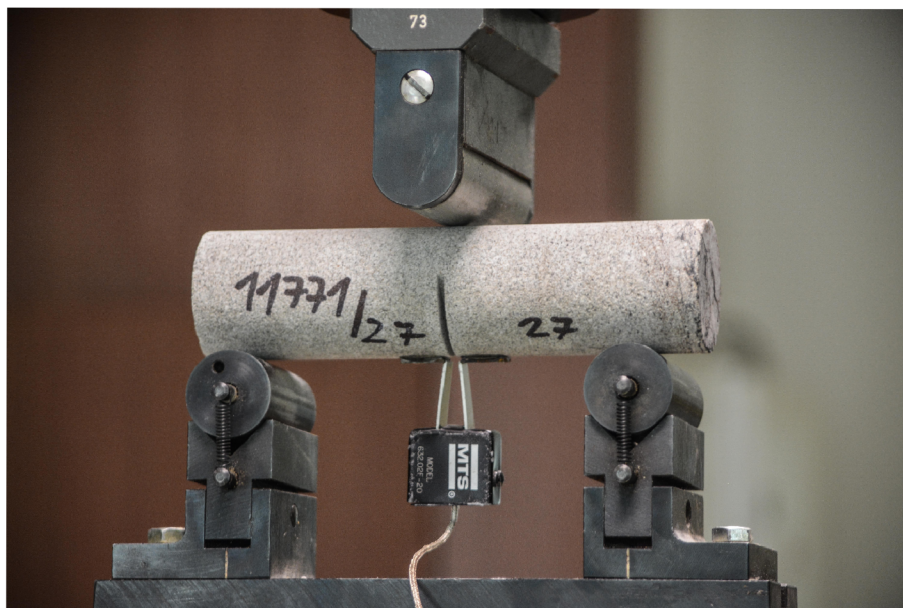
Obr. 5.1: Detail zkoušky pískovcového tělesa v lisu (Kubeš (2016))
