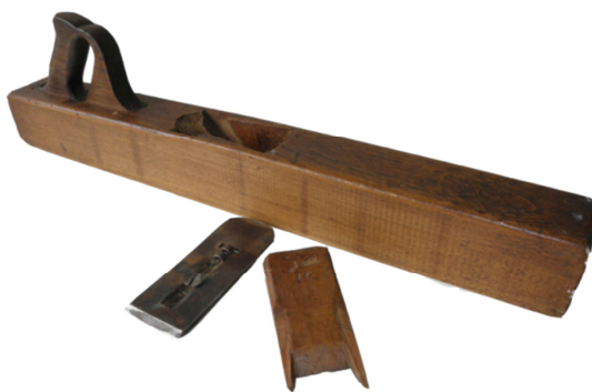
Obr. 5 Rozebraný hoblík (macek), sloužil na srovnávání velkých rovných ploch.
