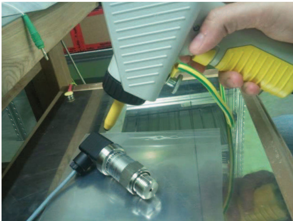
Obr. 25: Zkouška odolnosti proti elektrostatickému výboji na snímači DMP 331 (vzduchový výboj)
