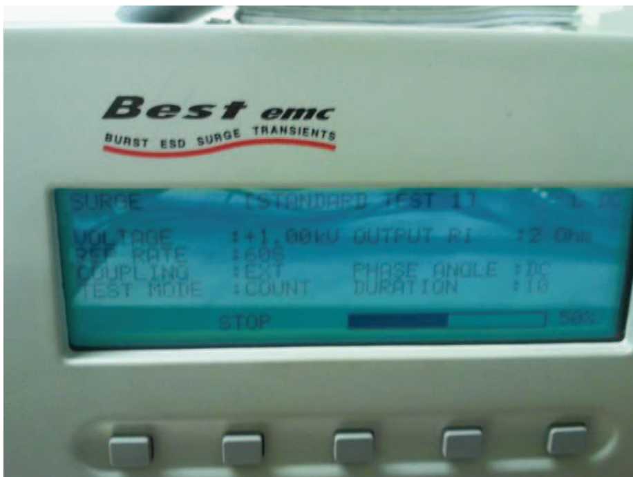
Obr. 23: Průběh a nastavení parametrů pro zkoušku odolnosti proti rázovým impulzům na simulátoru rušení BEST EMC SCHAFFNER
