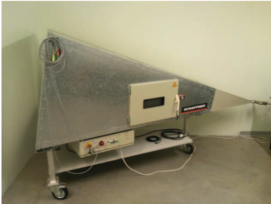
Obr. 19: Stíněná měřicí komora ve firmě BD SENSORS
