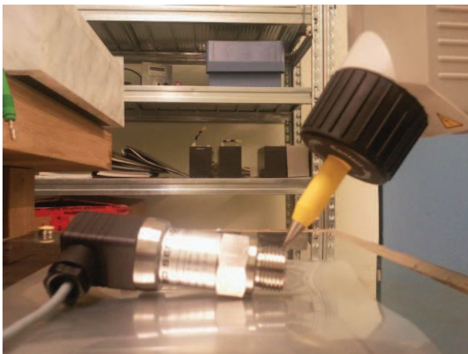
Obr. 24: Zkouška odolnosti proti elektrostatickému výboji na snímači DMP 331 (kontaktní výboj)
