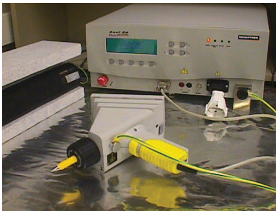
Obr. 7: Simulátor rušení BEST-EMC (Schaffner) se sondu pro elektrostatický výboj (ESD)
