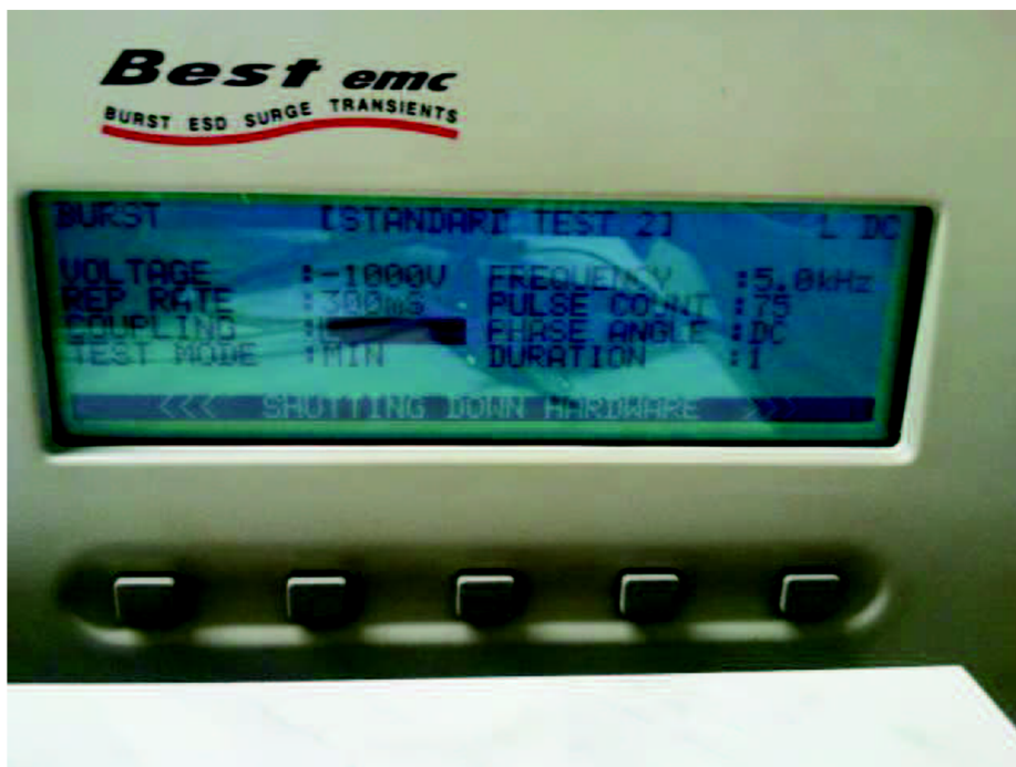
Obr. 22: Ukázka nastavení parametrů na displeji simulátoru rušení BEST EMC SCHAFFNER pro zkoušku odolnosti proti rychlým elektrickým přechodovým jevům / skupině impulzů
