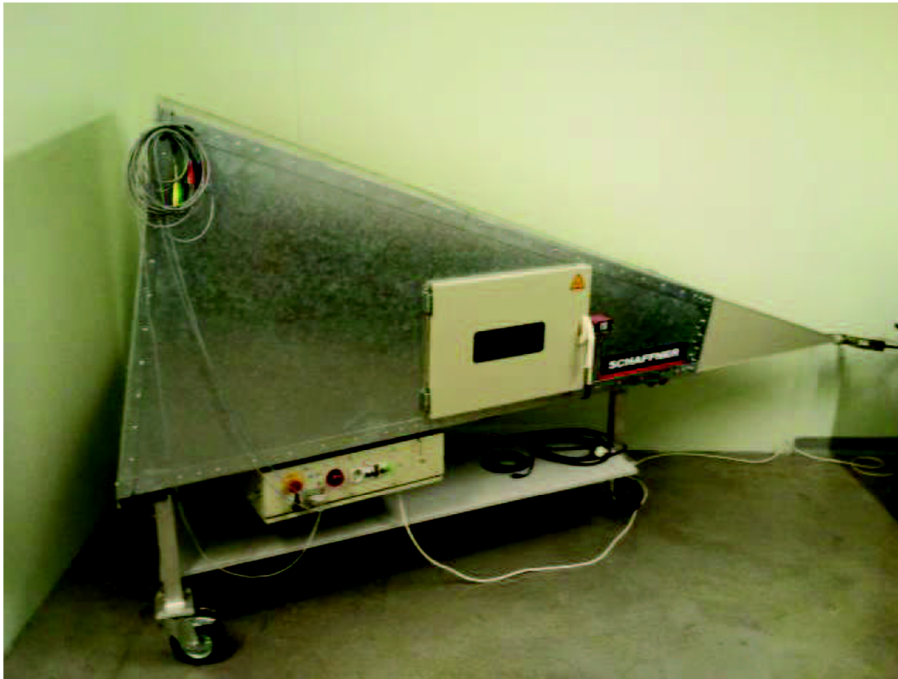
Obr. 19: Stíněná měřicí komora ve firmě BD SENSORS
