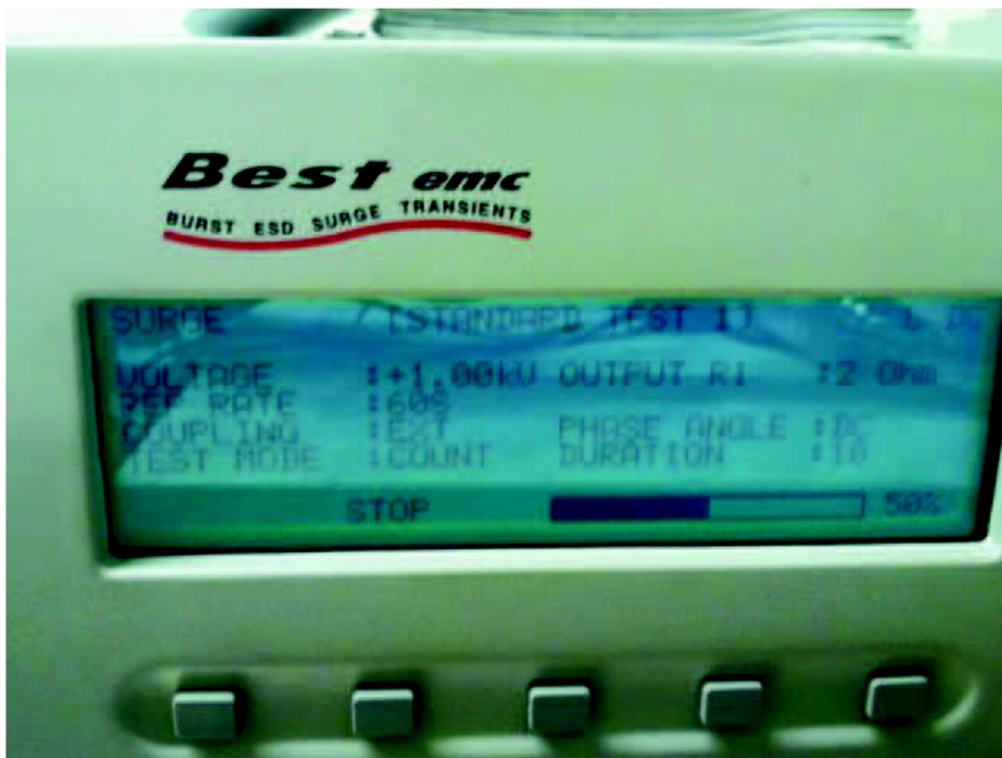
Obr. 23: Průběh a nastavení parametrů pro zkoušku odolnosti proti rázovým impulzům na simulátoru rušení BEST EMC SCHAFNER
