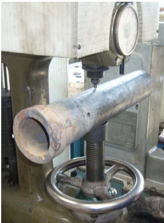
Obr. 3.5 Měření tvrdosti Trubky
