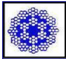
OBR. 1.1 Vícepramenné lano Herkules s 126 dráty
