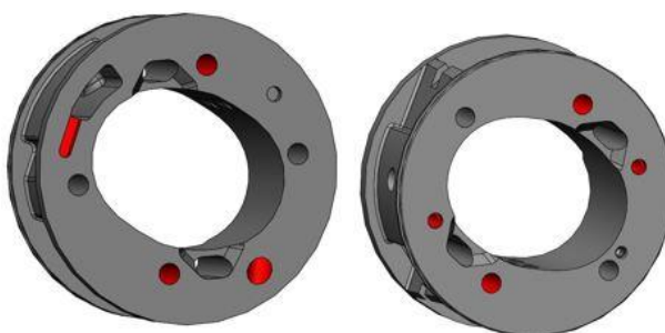
Obrázek 20 - Barevné označení obráběných ploch při 3. výrobní operaci [vlastní]
