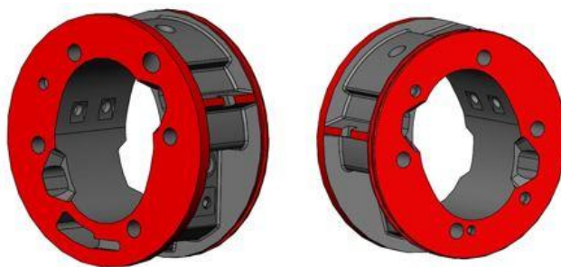
Obrázek 19 - Barevné označení obráběných ploch při 2. výrobní operaci [vlastní]
