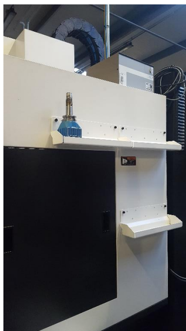
Obrázek 34 - Navržený prostor pro umístění náhradních nástrojů [vlastní]
