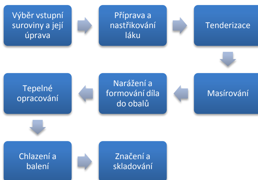
Obrázek 1: Schéma technologie výroby dušené šunky (BUDIG, XARGAYÓ, 2011a)
