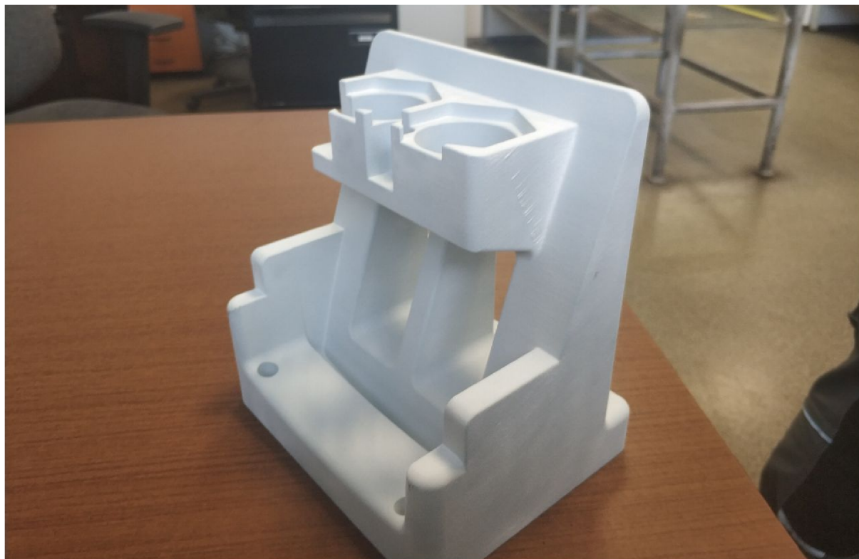
Obr. 2: Přípravek vyrobený na HP Multi Jet Fusion.
