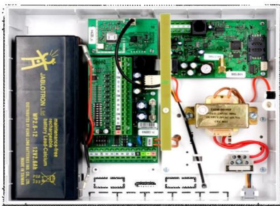
Obrázek 16 - Vnitřní uspořádání ústředny PZTS (21)
