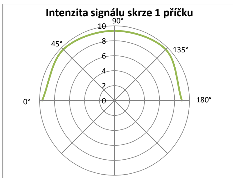
Graf 3 - Měření intenzity signálu v pásmu 868 MHz skrze 1 příčku
