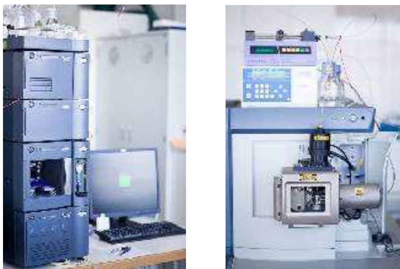
Obrázek 13: Kapalinový chromatograf Acquity (vlevo) a hmotnostní spektrometr Premier (vpravo). (Katedra Analytické chemie, Univerzita Palackého, Olomouc)
