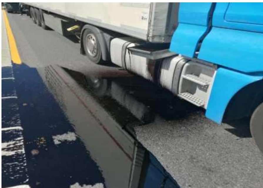
Obrázek č. 5 – Dopravní nehoda – únik provozních kapalin
