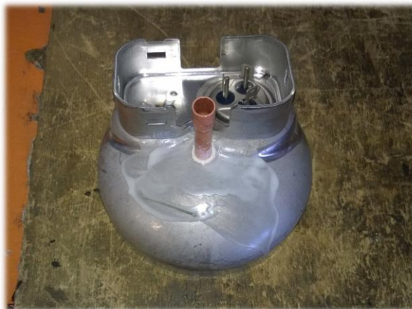
Obr. 47 Povrch opatřený pájecí pastou D60
