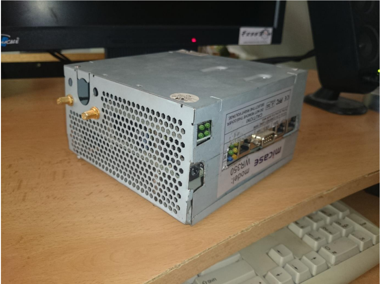
Obrázek 4.6 Ochranný case na RouterBOARD RB532A s daughterboardem RB502
