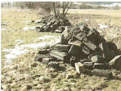
Obrázek 20 Vydané struskobetonové tvárnice Klas (CIFA, 2006)
