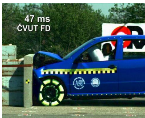
Obr. 29 1. kontakt řidiče s airbagem
