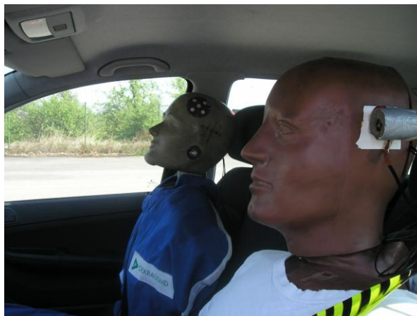
Obr. 24 Zkušební figuríny (zprava: Hybrid II, zleva: Manikin)
