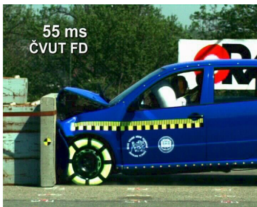
Obr. 35 Kontakt tuhé struktury s bariérou [zdroj: FD ČVUT]
