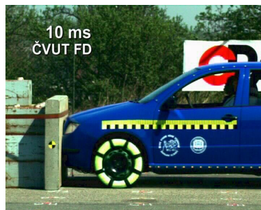
Obr. 34 Počátek deformace kapoty, blatníku a světel [zdroj: FD ČVUT]
