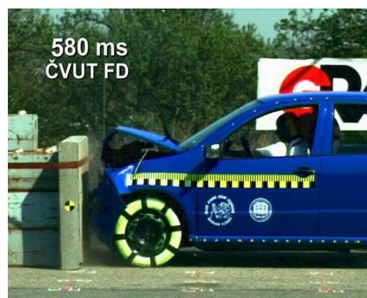
Obr. 36 Konec zpětného pohybu vozidla [zdroj: FD ČVUT]
