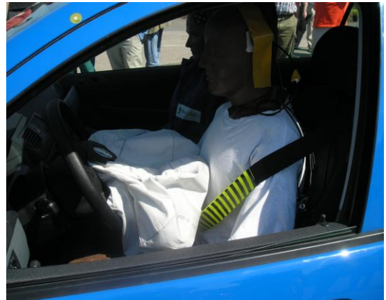
Obr. 25 Střet vozů s bariérou [zdroj: FD ČVUT] Obr. 26 Konečná poloha figurín (zprava: Hybrid II, zleva: Manikin) [zdroj: FD ČVUT]
