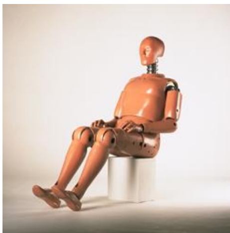
Obr. 16 Hybrid III 95. percentile Velký Muž [16]
