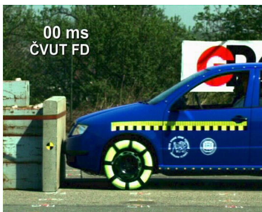
Obr. 33 První kontakt vozidla s bariérou [zdroj: FD ČVUT]
