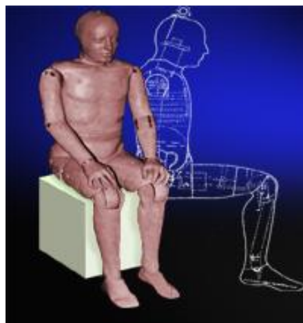
Obr. 17 Hybridní II 50. percentile Muž [16]
