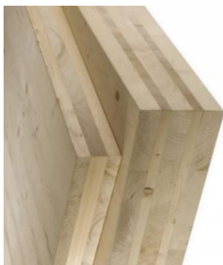
Obrázek 2: vrstvený masivní panel, Zdroj: (stavebnictvi3000.cz)
