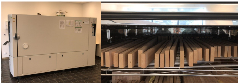
Obrázek 23 Klimatizační komora a pohled na zkušební tělesa (Autor)
