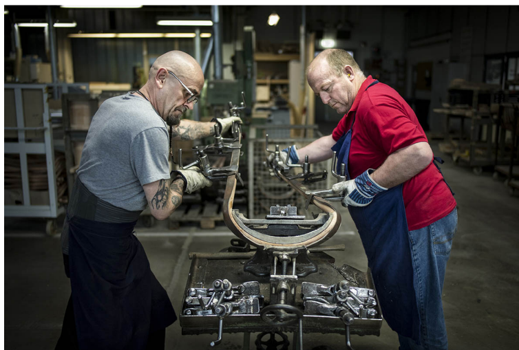
Obrázek 6 Výroba ručně ohýbaného dílce (Ton.eu, 2020)
