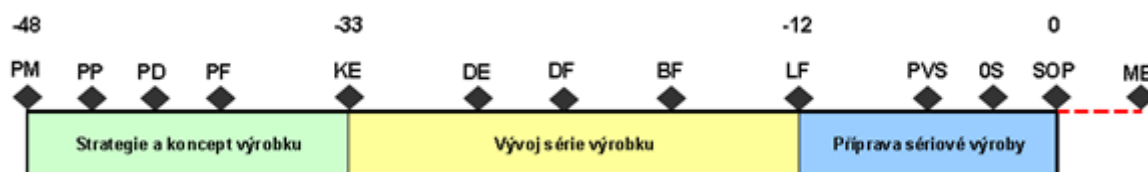
Obrázek 3 Etapy předcházející spuštění sériové výroby vozu. Zdroj: interní materiály Škoda Auto a.s.
