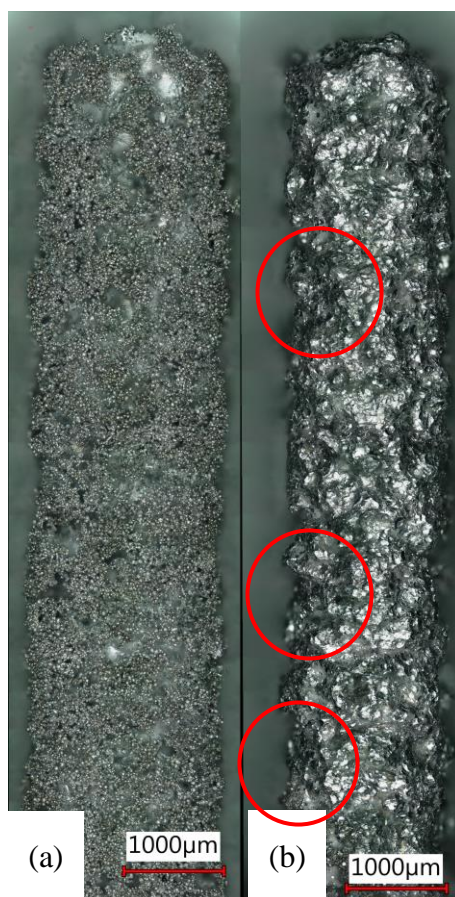
Obr. 5-12 Povrch jedného prútu so zvýraznenými miestami, kde nastalo odoberanie materiálu: (a) Prút po výrobe, (b) Prút po pieskovaní balotinou.
