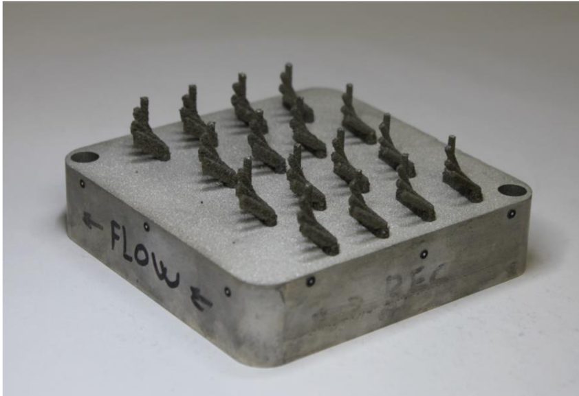
Obr. 4-6 Vyrobených 64 prútov s uhlami sklonu 90°; 65°; 45° a 35,26°
