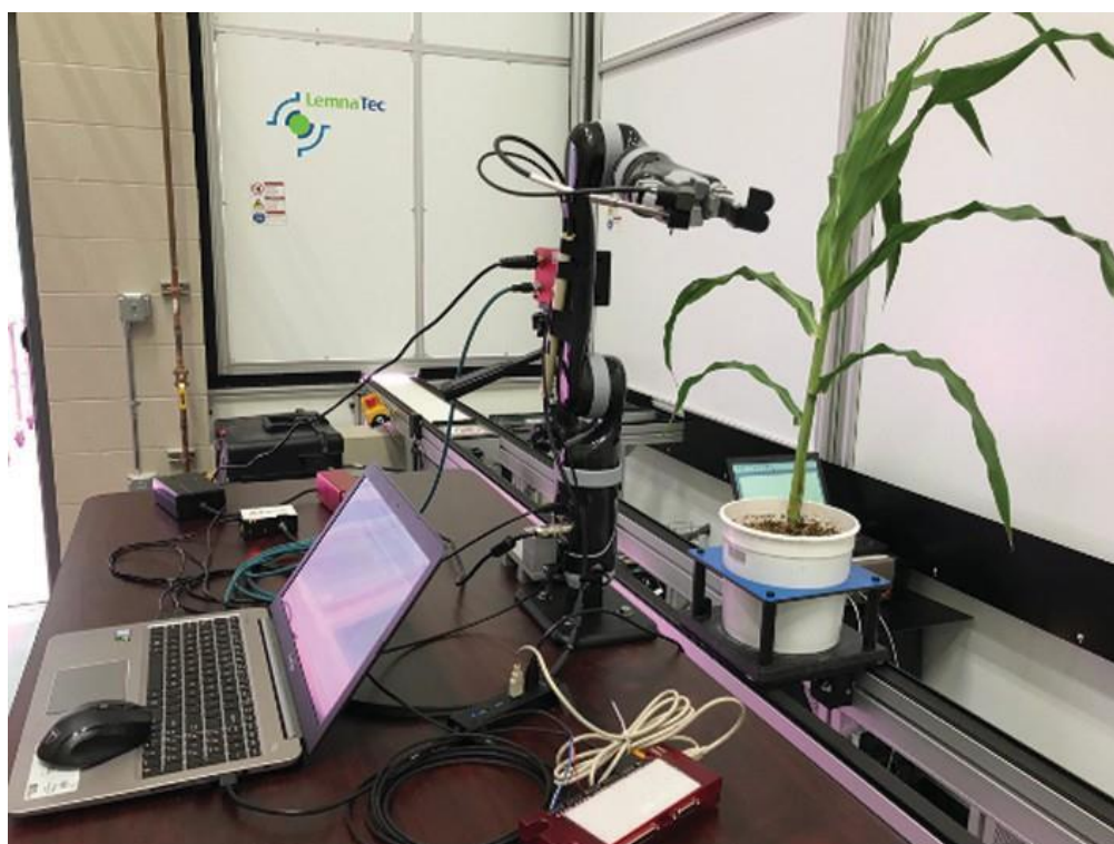
Obrázek 5: Robotické rameno provádějící fenotypizaci rostliny kukuřice ve skleníku. (Foto: Abbas Atefi, University of Nebraska-Lincoln).
