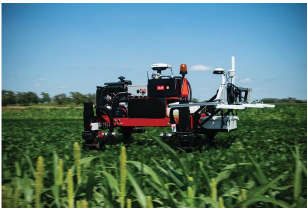
Obrázek 6: Flex-Ro, 60 HP UGV, sbírá informace o pozemku se sójou. (Foto: Santosh Pitla, University of Nebraska-Lincoln).
