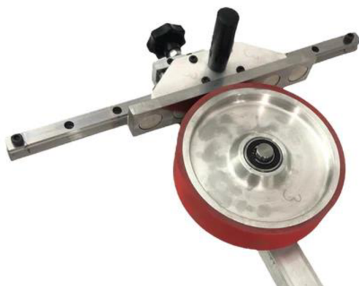
Obr. 10 Lineární magnetická bruska (přípravek) [9]
