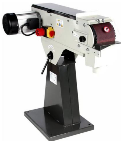
Obr. 4 Stojanová pásová bruska BS150 [4]
