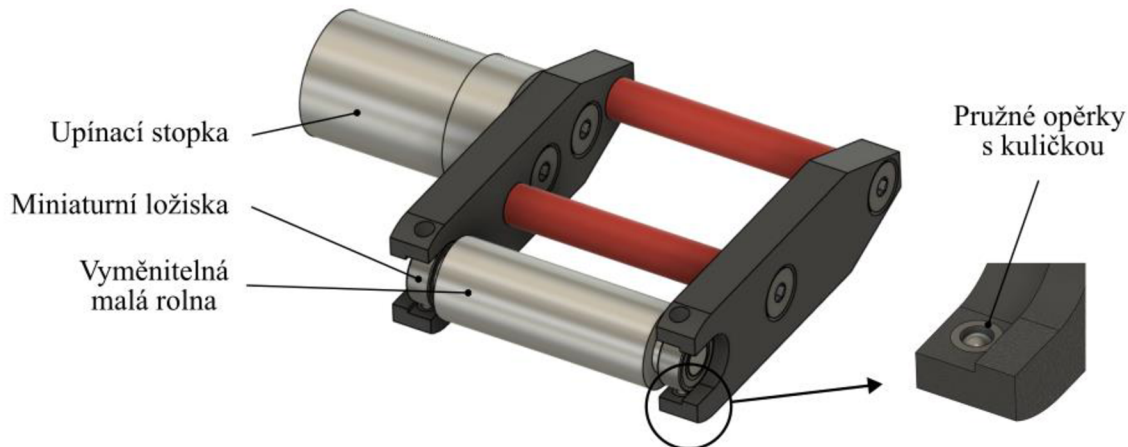
Obr. 43 Konstrukční řešení sady malých broušicích roln s držákem
