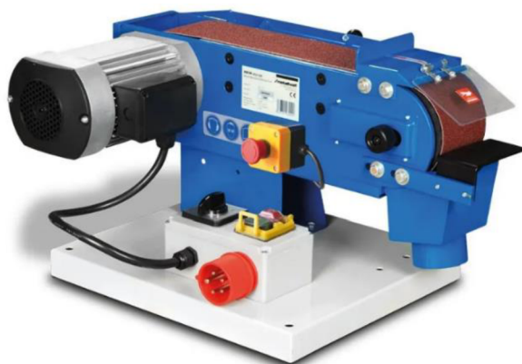
Obr. 5 Stolní pásová bruska MBSM 100-130-2 [5]
