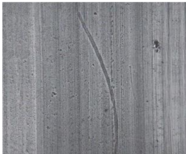
Obrázek 18: Vtisky způsobené částicemi nečistot na jedné oběžné dráze ložiska s čárovým stykem - zvětšeno 50x. [6]
