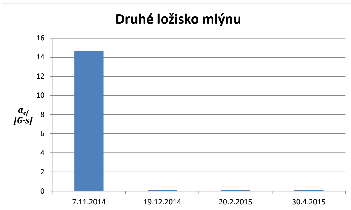
Graf 6: Efektivní hodnoty zrychlení druhého ložiska mlýnu linky SV4, měřicí místo č. 3 z obr. 3. Vyměněné ložisko po prvním měření ze dne 7.11.2014 jasně vykazuje nižší hodnoty vibrací a efektivní hodnota zrychlení se snížila o 99,2% na a_{ef}=0,1077 G·s.
