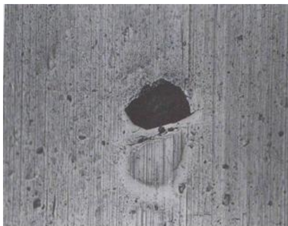
Obrázek 24: Odlupování (tmavá plocha) způsobené sousedními vtisky – 100x zvětšení [6]
