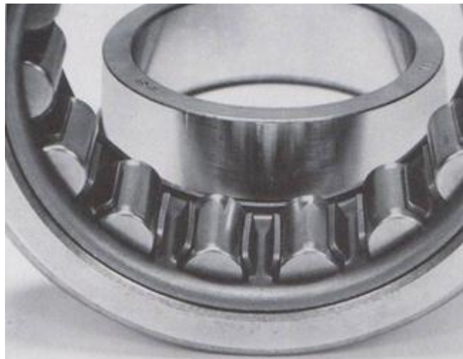
Obrázek 19: Válečkové ložisko s pruhy otěru na oběžné dráze vnitřního kroužku a na válečcích. Oděr byl vyvolán válečky, které byly namontovány našikmo, přičemž nebylo otáčeno ložiskem. [6]
