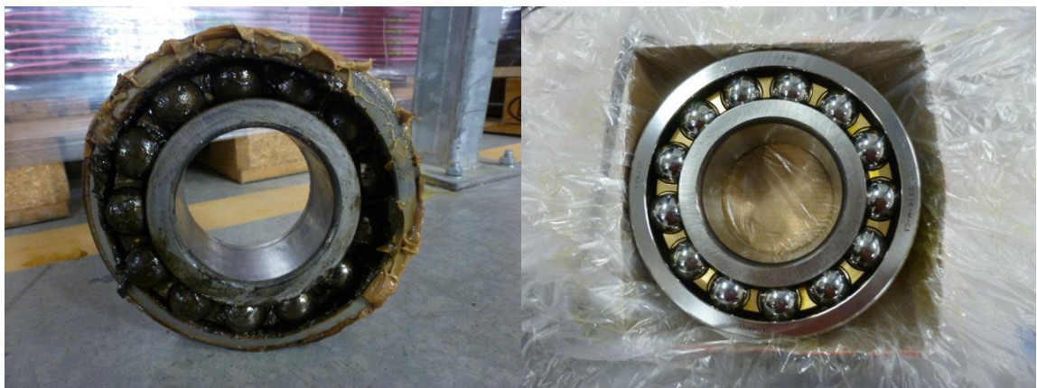
Obrázek 37: Staré porušené ložisko ve srovnání s novým ložiskem
