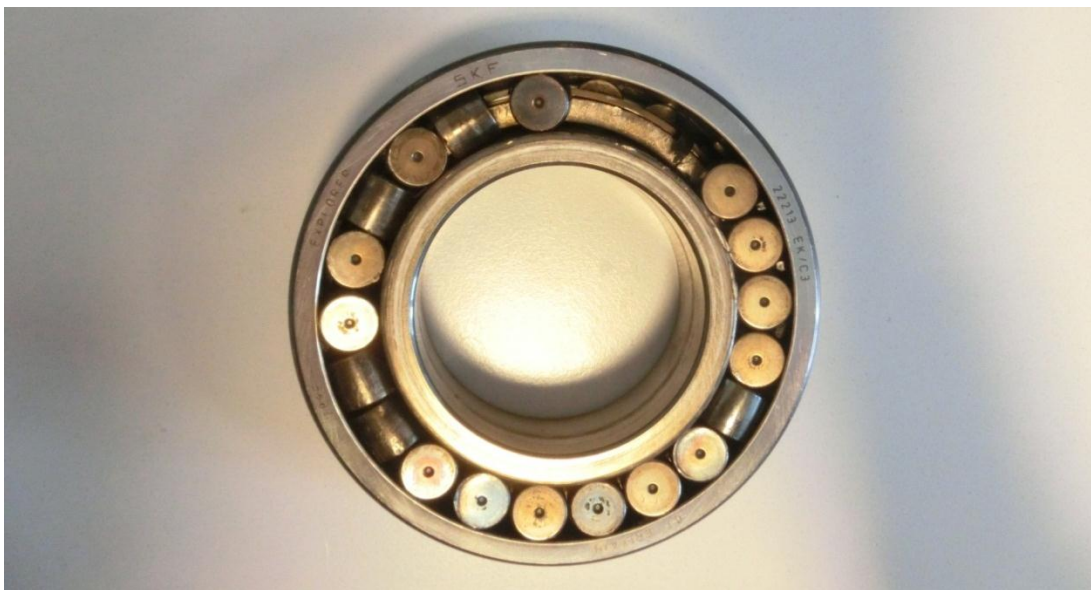
Obrázek 14: Porušené ložisko SKF 22213 EK/C3. Úplné zadření ložiska důsledkem defektu klece a následného vyosení soudečků z axiální polohy.
