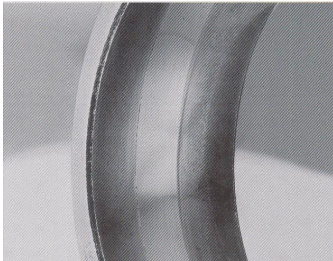
Obrázek 16: Vnější kroužek soudečkového ložiska s oběžnými drahami opotřebovanými abrazivními částicemi. Hranici mezi opotřebovanými a neopotřebovanými plochami lze rozpoznat hmatem. [6]
