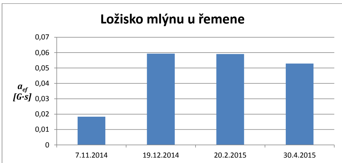
Graf 5: Efektivní hodnoty zrychlení ložiska mlýnu u řemene linky SV4, měřicí místo č. 2 z obr. 3
