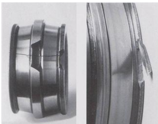
Obrázek 26: Vlevo prasklý vnitřní kroužek soudečkového ložiska. Vpravo vnitřní kroužek soudečkového ložiska s odlomenou částí vnější příruby. Poškození bylo způsobeno přímým úderem kladiva. [6]
