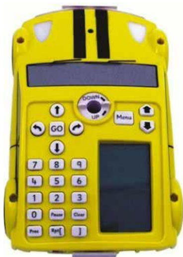
Obr. 2: Inteligentní kreslicí autíčko Pro-Bot + rozložení ovládacích tlačítek
