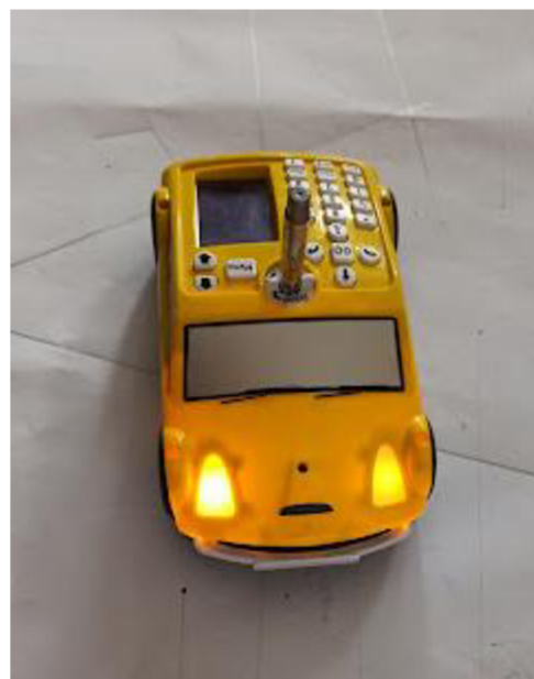
Obr. 83: Digitální didaktická pomůcka Pro-Bot s vloženým popisovačem a zapnutým světelným čidlem (zdroj: Vlastní zdroj autora)
