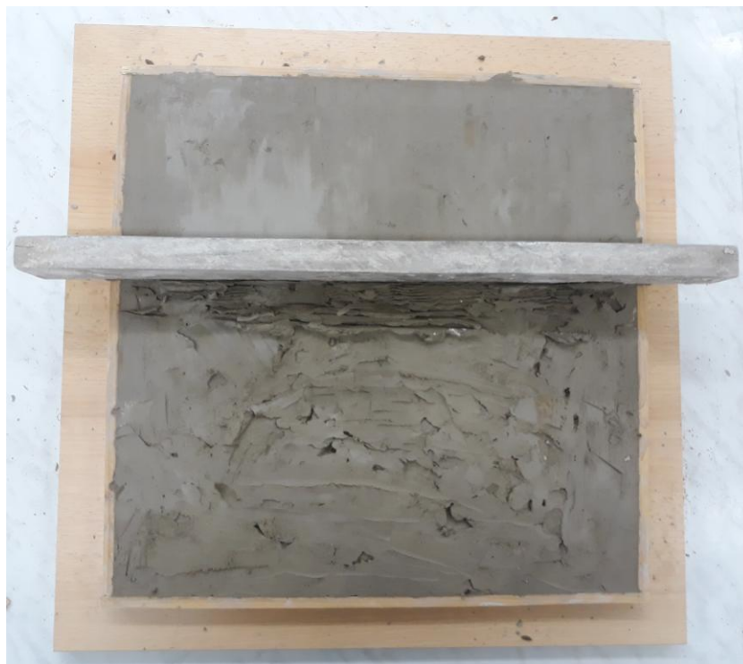
Obr. 5: Zarovnání rámečku s hlinou
