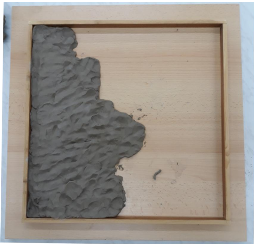
Obr. 3: Vyplňování rámečku pálenou hlinou
