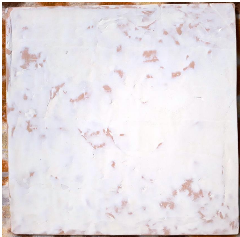
Obr. 27: Spodní část jezdce, upravena sádrou
